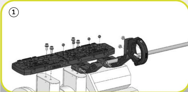
Die Grundplatte ist am Roboter angebracht. Die Kabelschelle ist am Seitenarm angebracht. Die Seitenarme/Tragarme sind an der Grundplatte angebracht. Die Aluminiumleiste wird durch Festziehen der Schrauben an den Armen befestigt.
