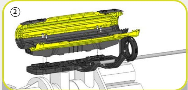
In der Standardausführung wird die LSH Delta mit einer Schraubverbindung an der Grundplatte befestigt.
