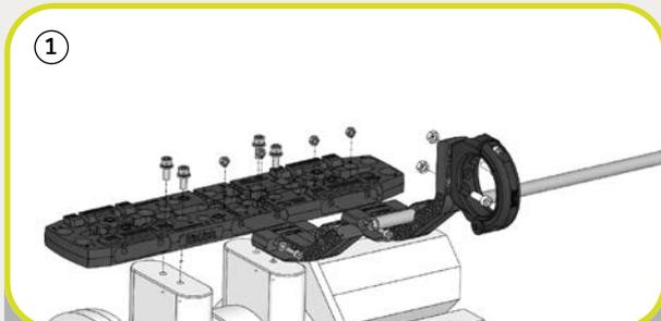
① La plaque de base est installée sur le robot. Le serre-câble est monté sur le bras latéral. Les bras latéraux/bras de support sont montés sur la plaque de base. La barre en alu est fixée sur les bras en serrant les boulons.
