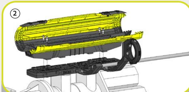
② Dans la version standard, le LSH Delta est monté sur la plaque de base à l'aide d'un raccord vissé.
