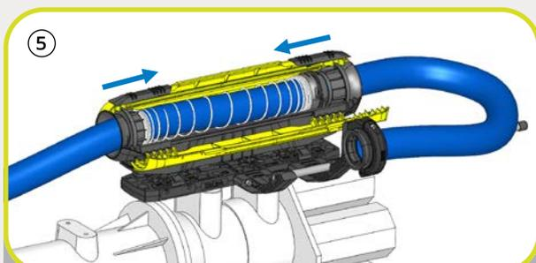
⑤ Le faisceau est inséré dans le LSH Delta. Le LSH Delta est fermé à l'aide des loquets de fermeture.
