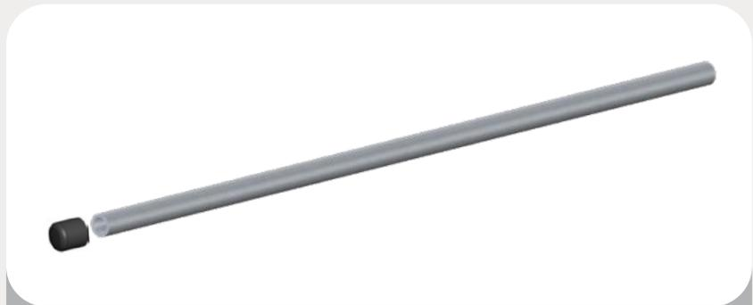
Placer l'embout (PSP00000012) sur le tube en aluminium (AAA00000043).
