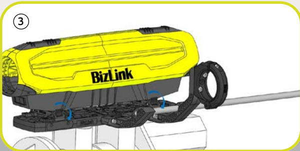
③ 在高级版中, LSH Delta 使用“滑-扣”适配器滑动安装至底板...
